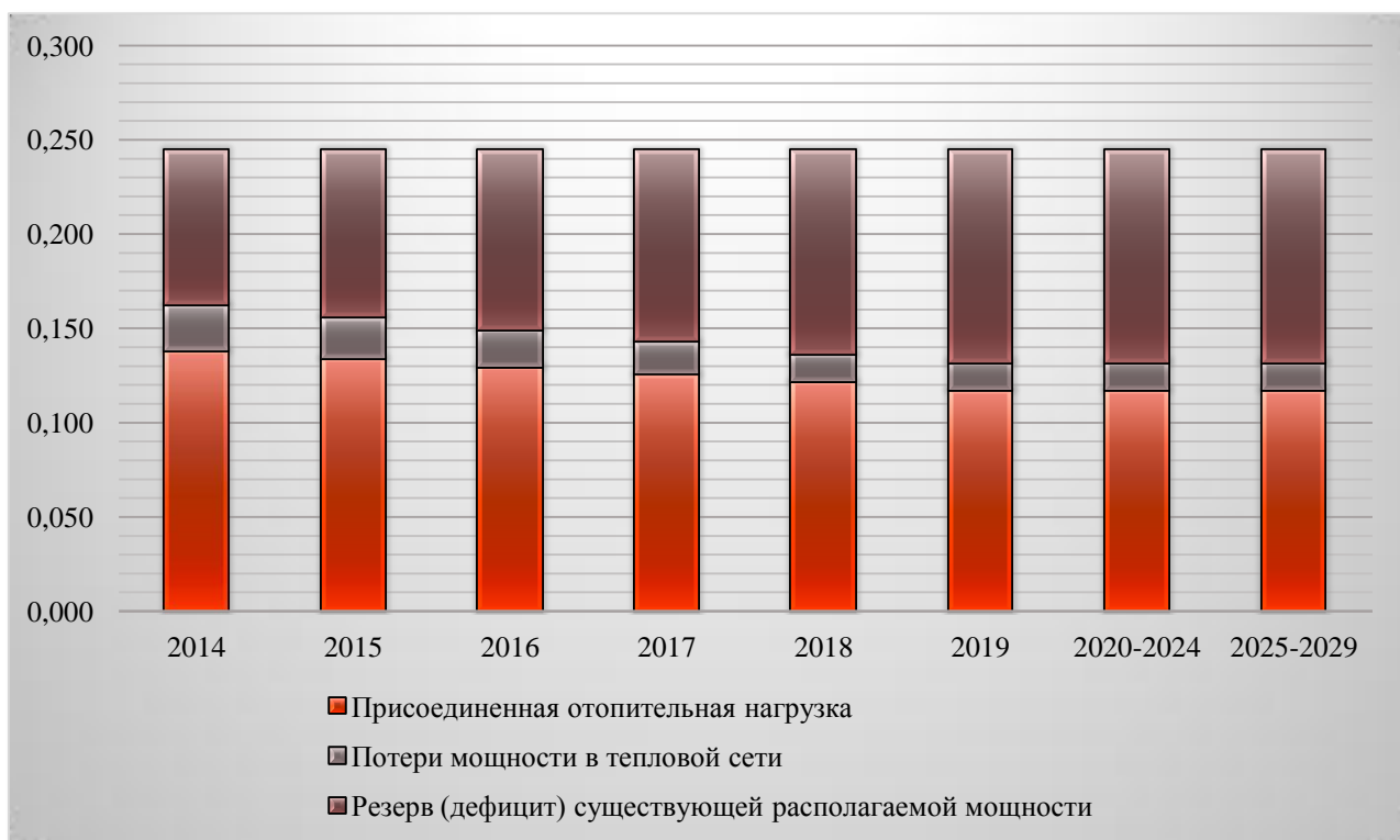
Рисунок 2-4.4. Балансы тепловой мощности и тепловой нагрузки по магистральному выводу котельной «Школа-интернат», Гкал/ч
