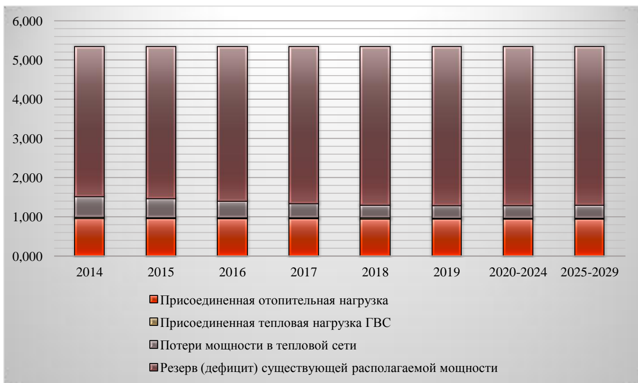
Рисунок 2-4.8. Балансы тепловой мощности и тепловой нагрузки по магистральному выводу котельной «п. Диск», Гкал/ч
