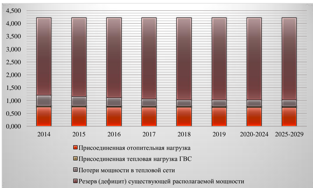
Рисунок 2-4.7. Балансы тепловой мощности и тепловой нагрузки по магистральному выводу котельной «ОПФ», Гкал/ч
