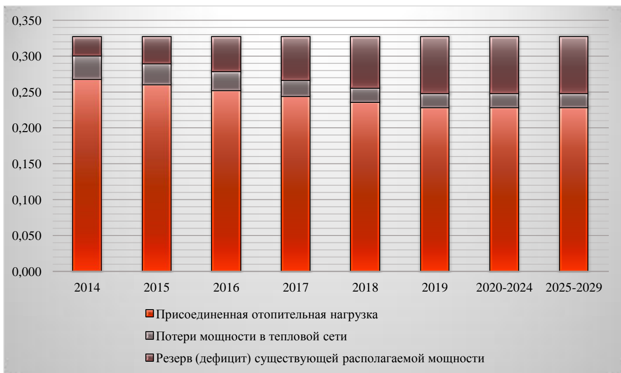
Рисунок 2-4.2. Балансы тепловой мощности и тепловой нагрузки по магистральному выводу котельной СОШ № 1, Гкал/ч
