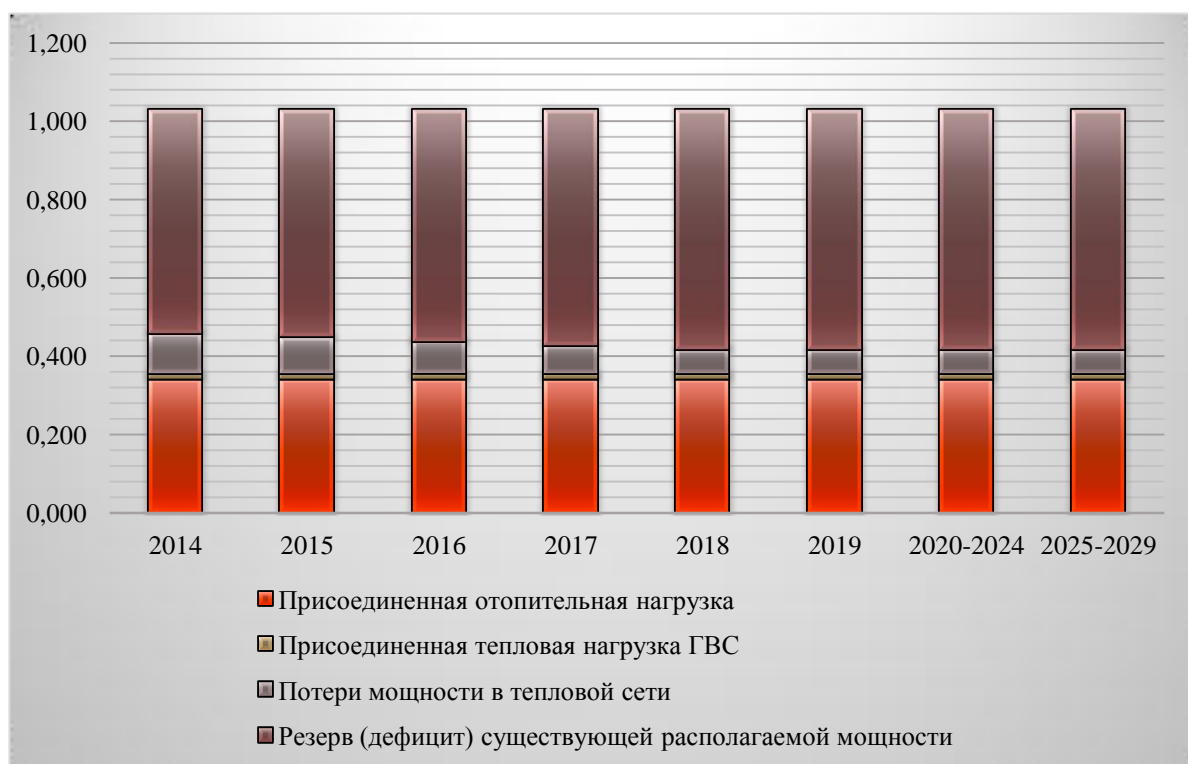
Рисунок 2-4.11. Балансы тепловой мощности и тепловой нагрузки по магистральному выводу котельной «ул. Терешковой», Гкал/ч
